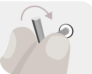
Coloca la alcayata dentro del taco girandola hasta que quede en vertical.
