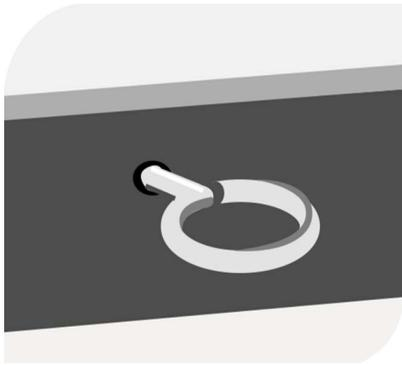
Coloca 2 hembrillas a la trasera del cabecero (a unos 10-15 cm del filo superior y a unos 10 cm de cada lateral). Coloca cabecero en sitio definitivo y presiona con ligero golpe seco a cabecero a la altura de las hembrillas. Dejaras 2 marcas leves en pared. (Recuerda que cabecero va apoyado en suelo no precisa colgar).
